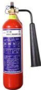
压下，液态的二氧化碳会立即汽化，一般 1kg 的液态二氧化碳可产生约 0.5 立方米的气体。因而，灭火时，二氧化碳气体可以排除空气而包围在燃烧物体的表面或分布于较密闭的空间中，降低可燃物周围或防护空间内的氧浓度，产生窒息作用而灭火。另外，二氧化碳从储存容器中喷出时，会由液体迅速汽化成气体，而从周围吸收部分热量，起到冷却的作用。
